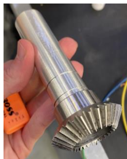
Figure 20 : Photo de l'arbre creux usiné avec roue conique frettée.
