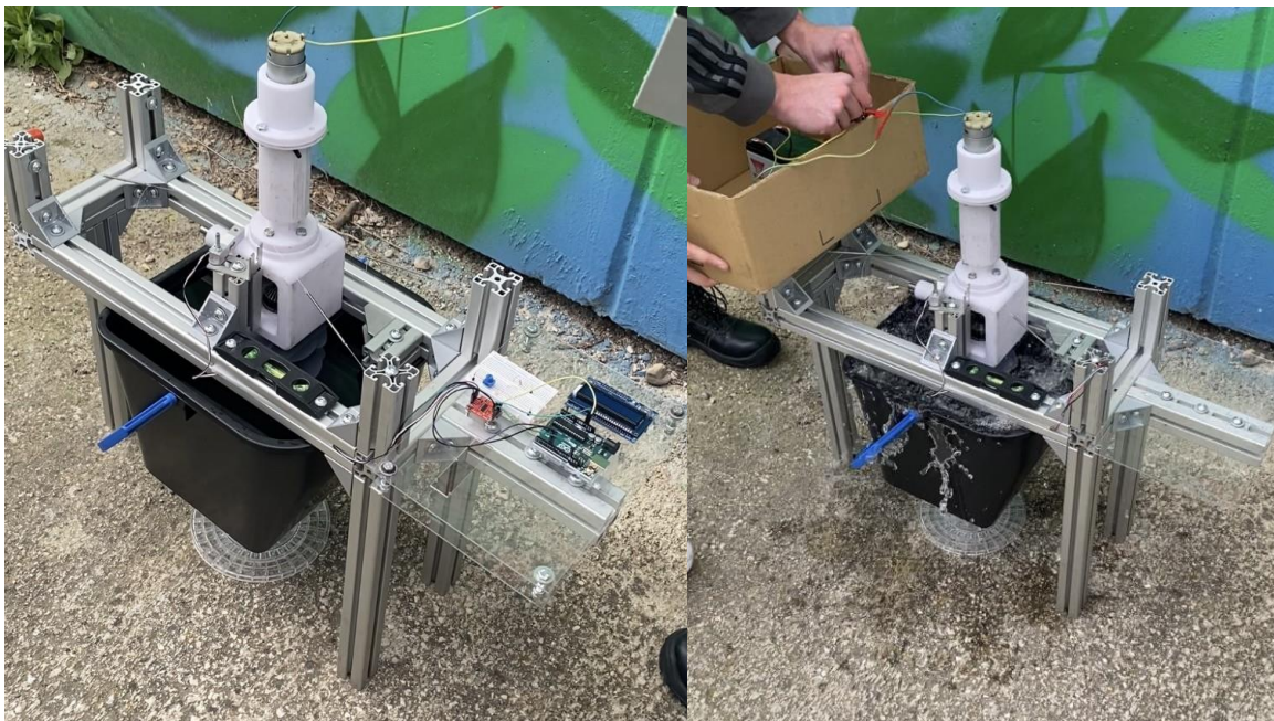
Figures 35 et 36 : Photos du premier test du banc d'essai à l'arrêt et en action (avec projections d'eau).
