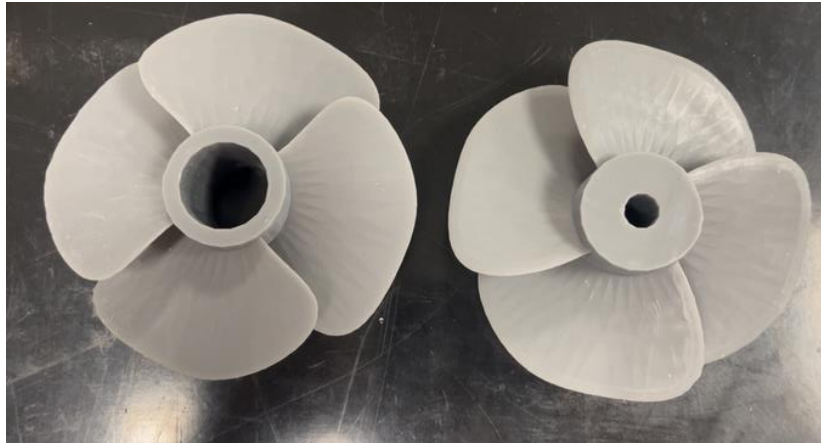
Figure 28 : Photo hélices impression 3D bain de résine SLA.
