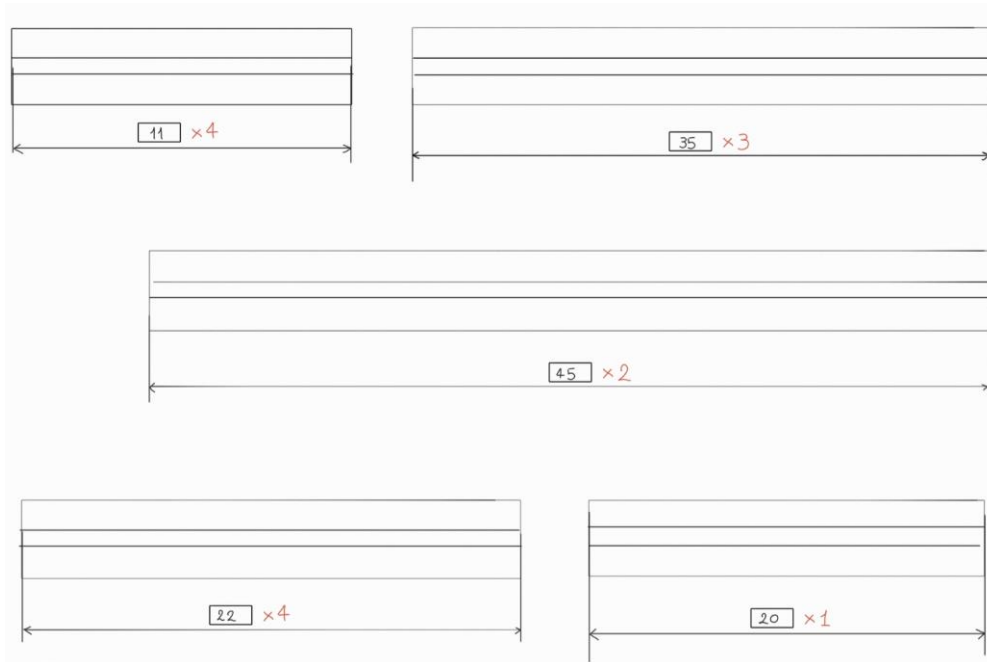
Annexe 7: Dimensions des profilés du banc d'essai pour découpe.
