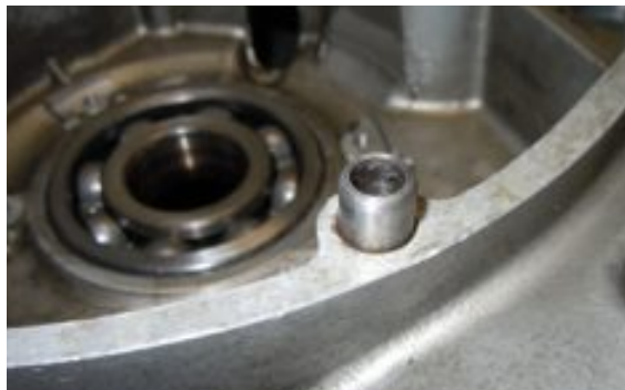
Figure 23 : Photo de carter de moteur thermique avec un montage de pions de centrage cylindrique
