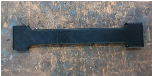
Figure 31: Eprouvette correctement imprimée
