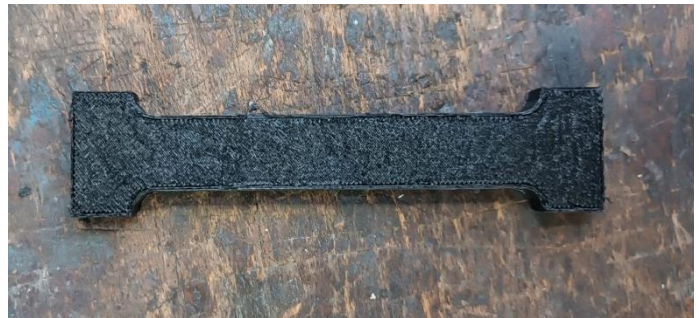
Figure 32: Eprouvette dont l’impression n’est pas allée à terme
