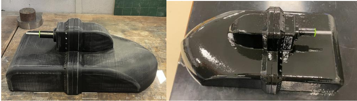
Figure 25 : Préparation et pose de la résine.
