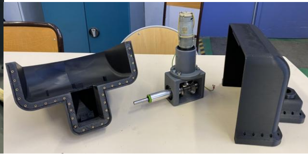
Figure 23 : Différentiel monté et demi-coques.
