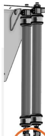
Figure 24 14 Fixation du câble aux muscles pneumatiques
