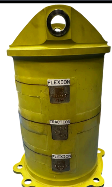
Jauges d'extensométrie (pièce cylindrique © Airbus)
