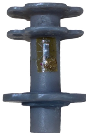
Image 20 : Tentative d'installation d'une jauge de contrainte sur le moyeu en résine. Collage réussi (un des trois réussis) mais le soudage des fils sur le moyeu a été un échec.
