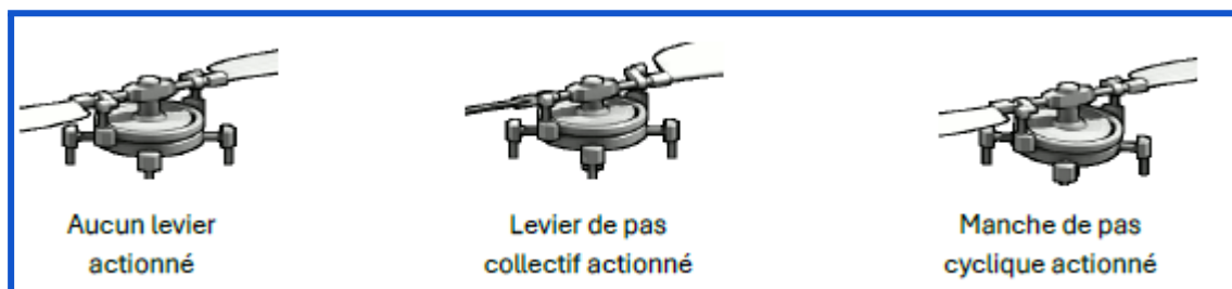
Figure 4 : Illustration de différentes incidences de pale
