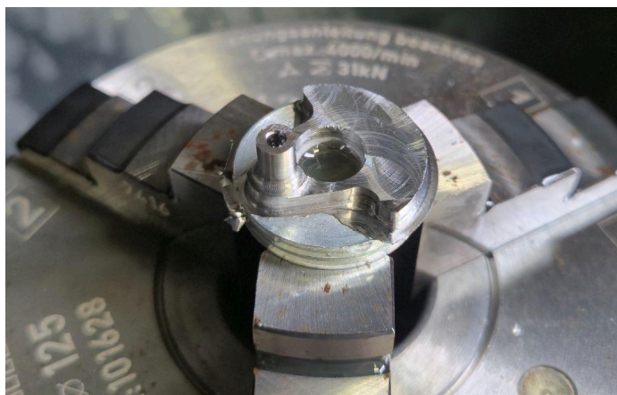
Figure 23 : Image - Usinage du vilebrequin.
